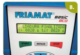
Una vez completado el ciclo de fusión, se deben chequear los indicadores. Luego, desconectar los cables del fitting, dejando sujeta la tubería durante el ciclo de enfriamiento recomendado por el proveedor. No se debe realizar ninguna prueba de presión hasta completar los tiempos mínimos de enfriamiento y de espera recomendados.
