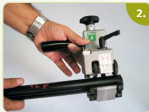
Limpiar la zona de fusión de la tubería con un paño limpio y seco y raspar la circunferencia completa, verificando que se extraiga una cinta continua de PE.
