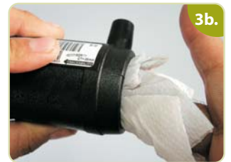
Con un papel absorbente, retirar la grasa del fitting a fusionar, usando un agente de limpieza adecuado (isopropanol o etanol).
