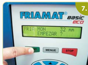
Ingresar los datos de fusión por medio del código de barra incorporado en el fitting. Revisar la información de fusión en la pantalla de la unidad de control.
